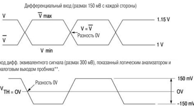
Вход дифф. эквивалентного сигнала (размах 300 мВ), показанный логическим анализатором и аналоговым выходом пробника\*\*.
